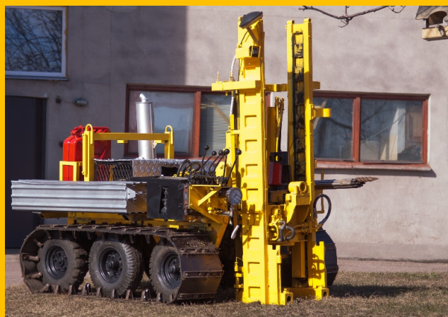
1. attēls. WST (svarzondēšanas) iekārta GEOTEK-1000
